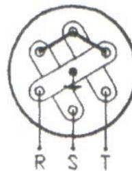
Collegamento a triangolo riscaldatore a 3 el.
